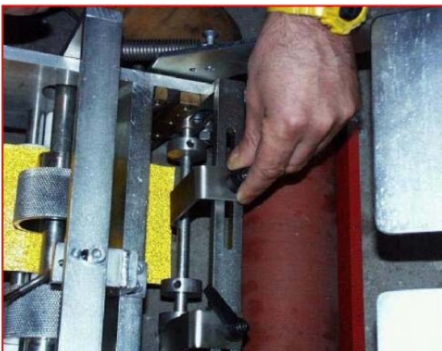
Figura 6: Ajuste del plato guía vertical
