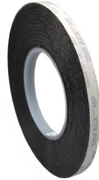
El núcleo de espuma acrílica viscoelástica de tesa® ACX<sup>plus</sup> 7262 multiusos absorbe las cargas estáticas a la perfección. Debido a su fórmula única, esta cinta de espuma acrílica de doble cara logra compensar las dilataciones térmicas de las piezas unidas.
